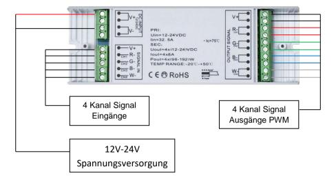
Ein **Repeater** (englisch wörtlich für "Wiederholer"), oder *Regenerator /* **Verstärker** genannt, wird eingesetzt, um Signalkanäle eines Mastergerätes zu erweitern.
