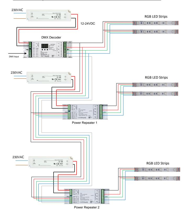
Das oben gezeigte Anschluss-Diagramm zeigt die Konstant Spannung Variante. Achten Sie darauf, dass die Netzteile erst nach kompletter Installation mit der Stromquelle verbunden werden!
